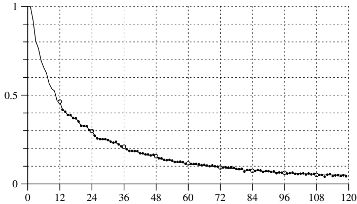
Abb. 14.1-4 Aus der Minimierung der im Text angegebenen Zielfunktion berechnete Survivorfunktion für die Jahresraten u_{97}(t) .
